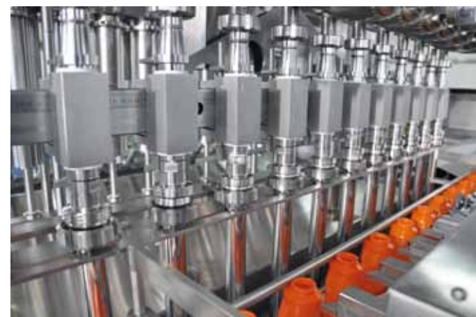
Auto-CIP* Automatisches Einfahren der Fülldüsen in CIP-Position
